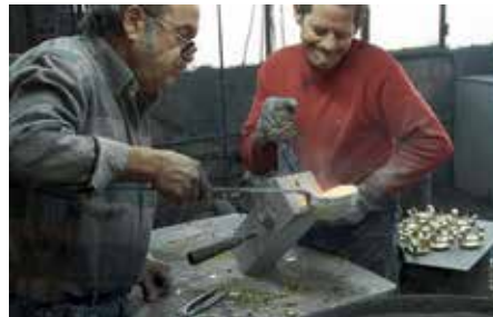
Trabajo de fundición a partir de un lingote de latón.
